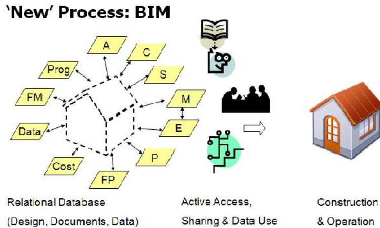
Fig. 3. BIM Design Workflow
